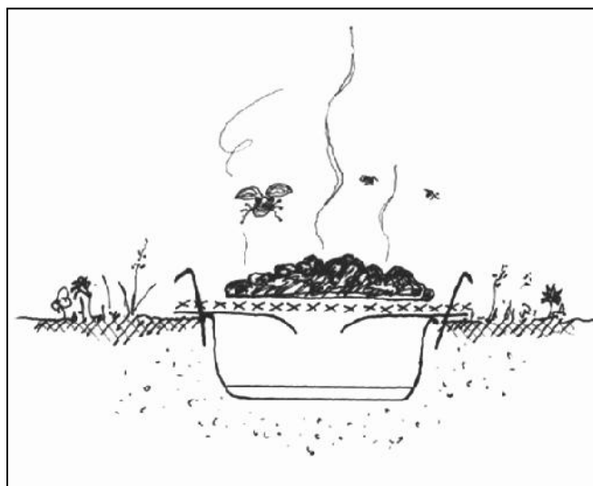
Fig.14. Piège de type C.S.R. Vu en coupe (Dessin : X. HOUARD).
