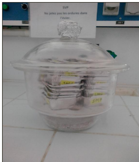
Figure 06: refroidissement des échantillons (Photo personnelle)
