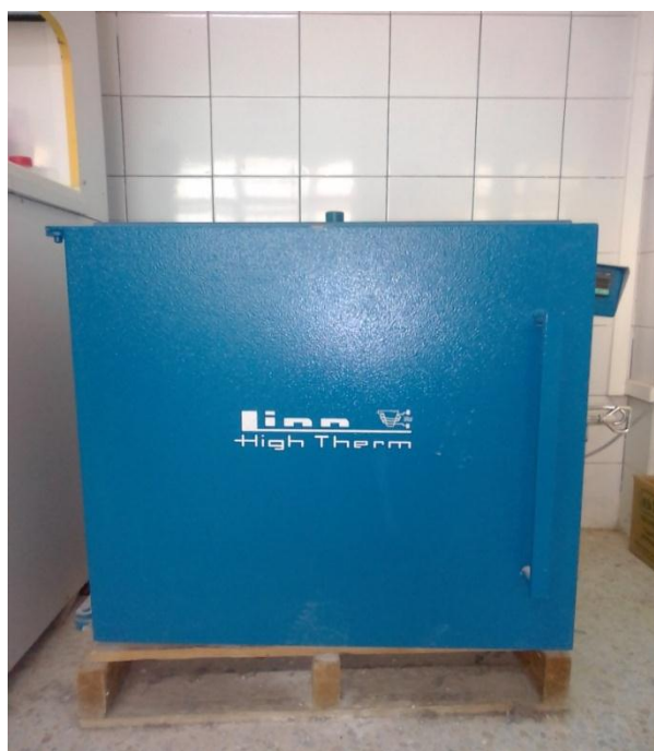
Figure 17 : Un four à moufle utilisé pour la calcination
