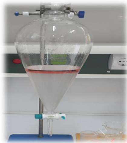
Figure 28 : Photographie représentant l'extraction liquide-liquide
