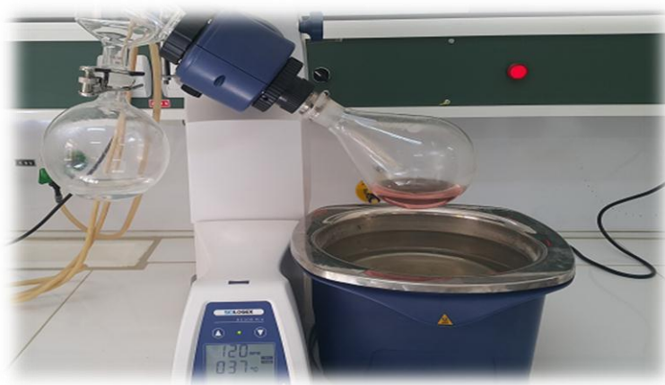
Figure 29 : Photographie représentant un appareil Rotavapor
