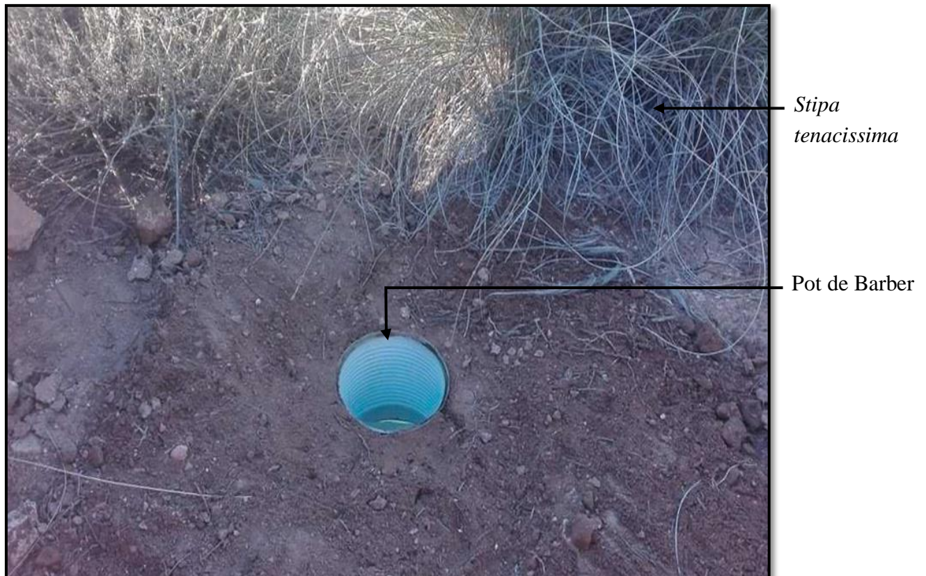
Fig.12 - Un pot de Barber installé dans la steppe à Stipa tenacissima (Originale)
