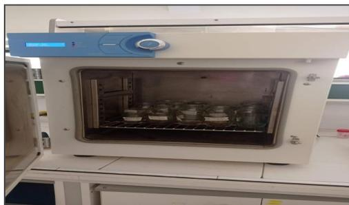
**Figure 18**: Mise des échantillons à l'étuve pendant une heure à 90 °C (Original, 2022)
