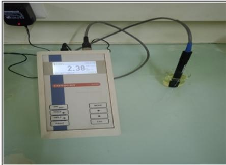
**Figure 12** : Appareil de mesure de la conductivité (Original, 2022)
