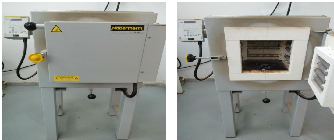
Figure IV.1: Four électrique à moufles utilisé pour les traitements.
