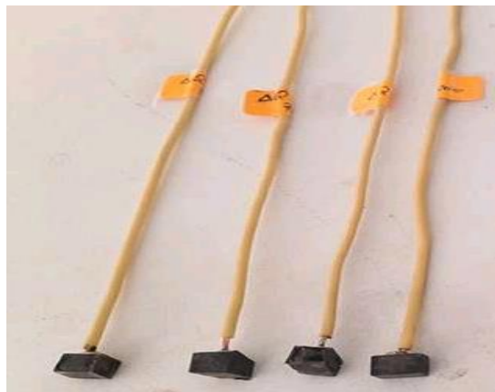
Figure IV.8: soudure du fil électrique sur la surface.
