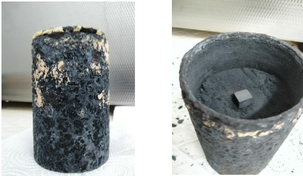
Figure IV.6: la poudre de bore et l'échantillon dans le creuset.
