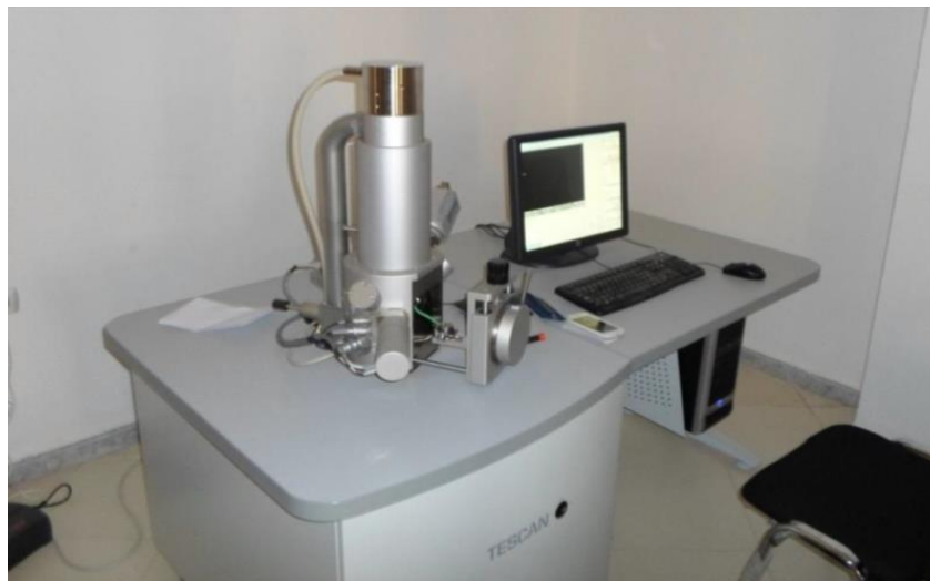
Figure IV.18: Microscope électronique à balayage ( TESCAN ) (Laboratoire de recherche de génie des procédés).
