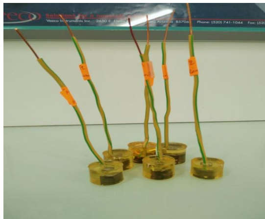
Figure IV.9: recouvrement de la surface soudée par l'enrobage.
