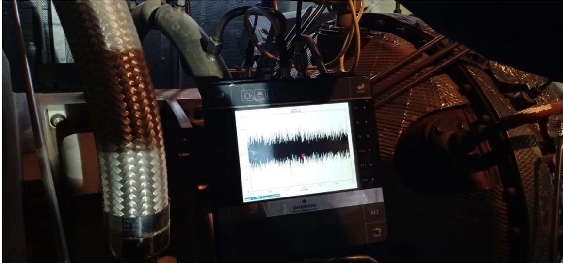
Figure (II-17) : Lecture et enregistrement des signaux sur l'appareil CSI 2140
