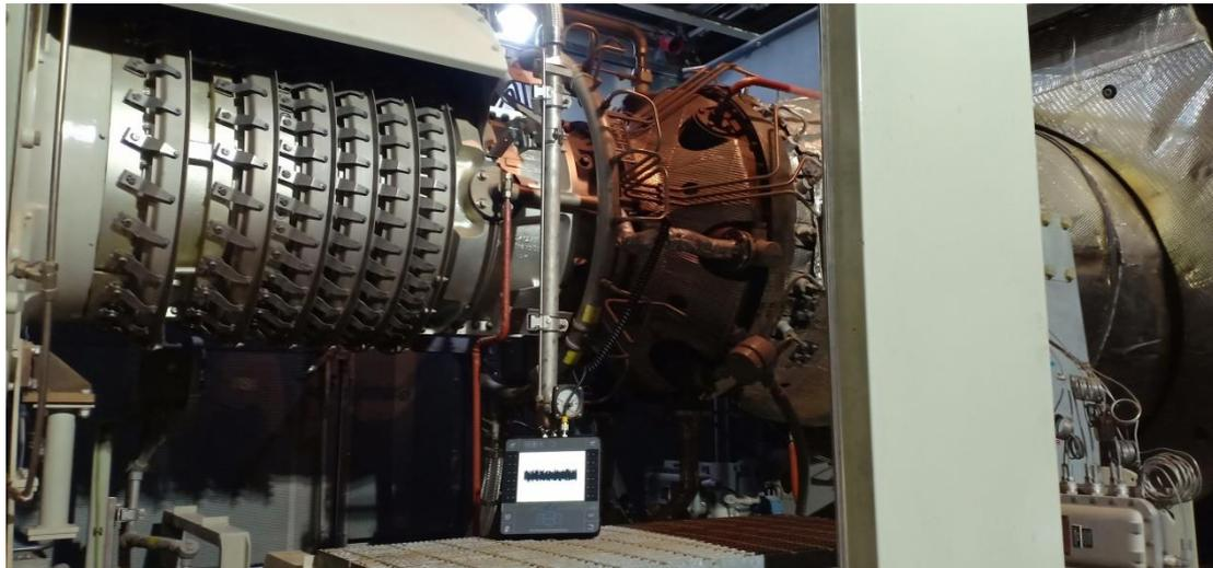
Figure (II-16) : Emplacement de l'appareil CSI 2140 sur la turbine TITAN 130
