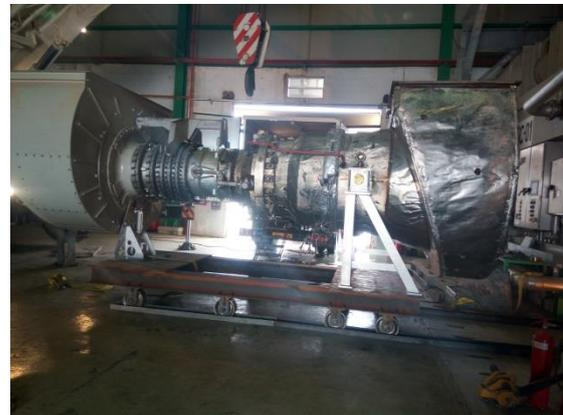
Figures (I-4) : Turbine démontée de son package
