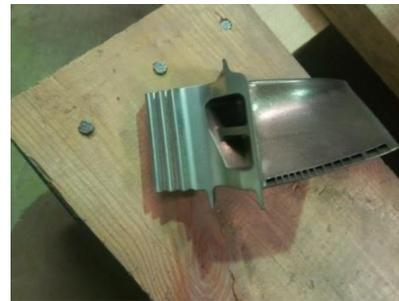
Figures (I-10) : Roue Mobile 3<sup>ème</sup> étage Turbine GG- (d) (aube)
