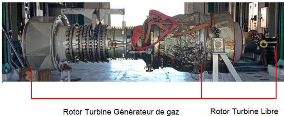
Figure (I-18) : Vue panoramique de la ligne d'arbre Solar Turbine TITAN 130 (photo sur site)
