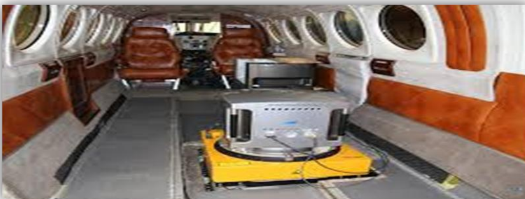
FigureI.8 : Avion équipé d'une caméra métrique
