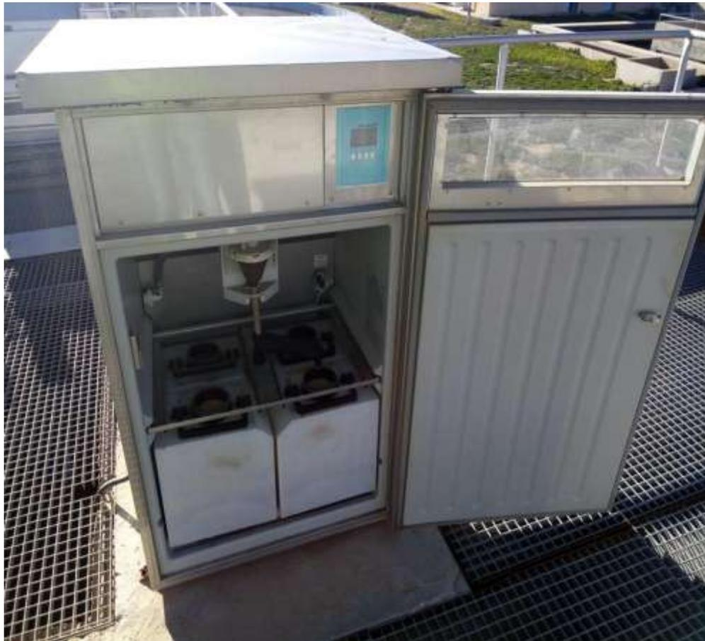
**Figure III.5 : Préleveur d'échantillons automatique**
