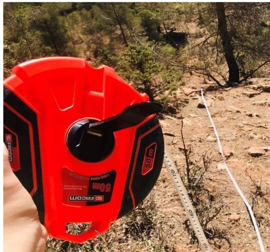
**Figure 3.2:** Ruban mètre de 50 m utilisé pour déterminer la surface du relevé (ORIGINALE., 2023)
