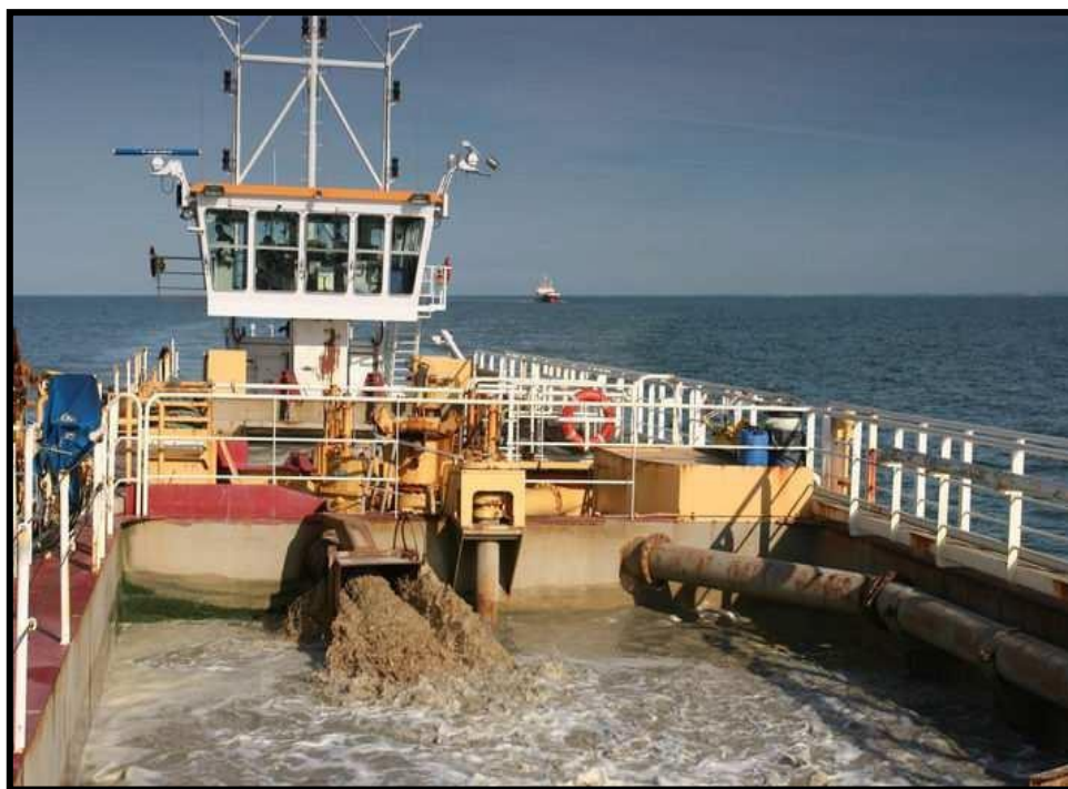
Figure 25 : Refoulement de matériaux dragués dans le puits de la drague
