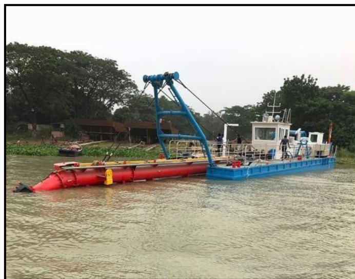
Figure 23 : la drague aspiratrice en état de fonction
