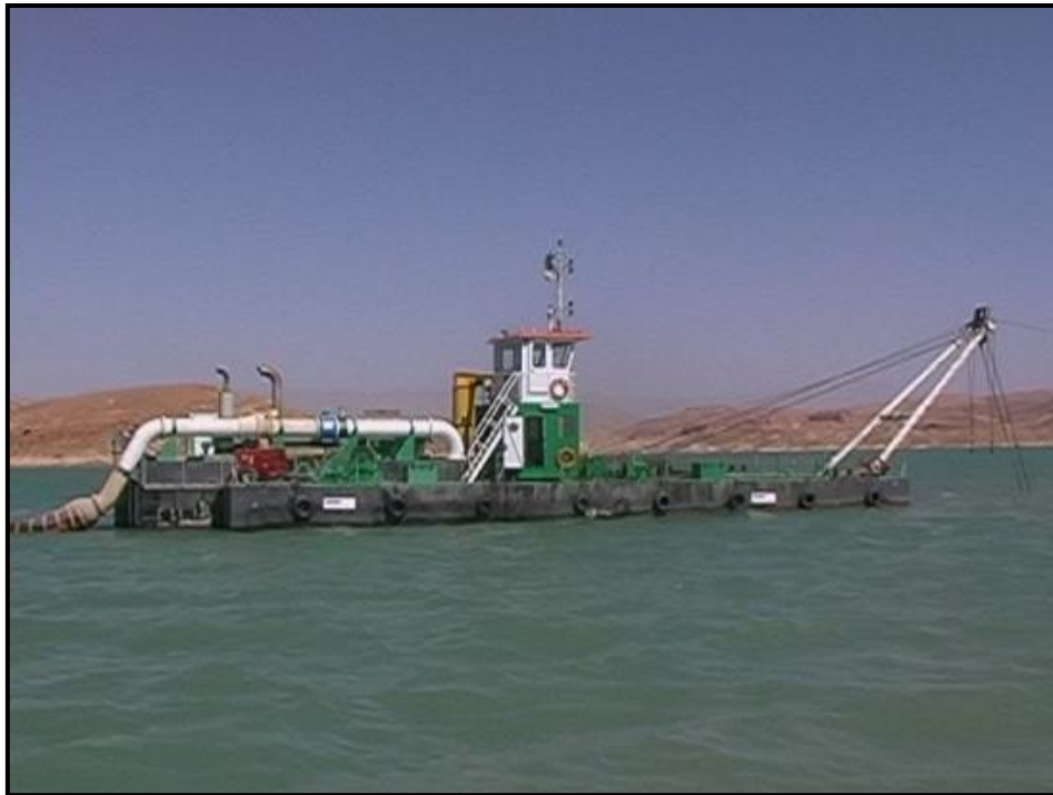
Figure 24 : La drague dans le barrage (ANBT)
