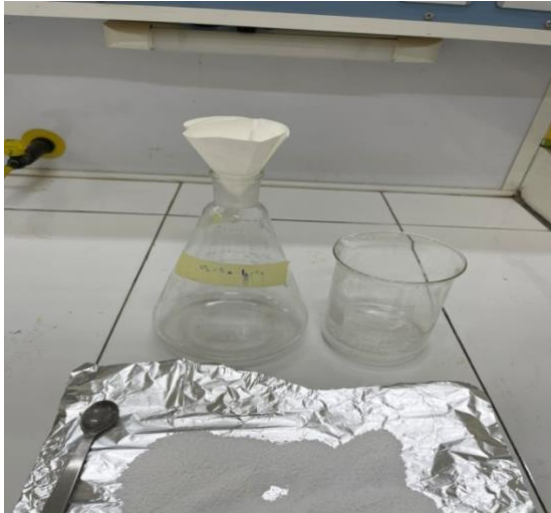
Figure18: Filtration des traces d'eau par MgSO_4
