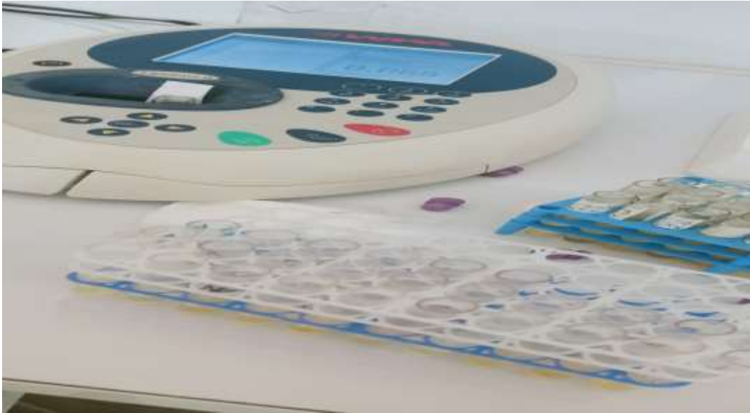
Figure 10 : Dosage du Cr(VI) par spectrophotométrie UV-Visible.
