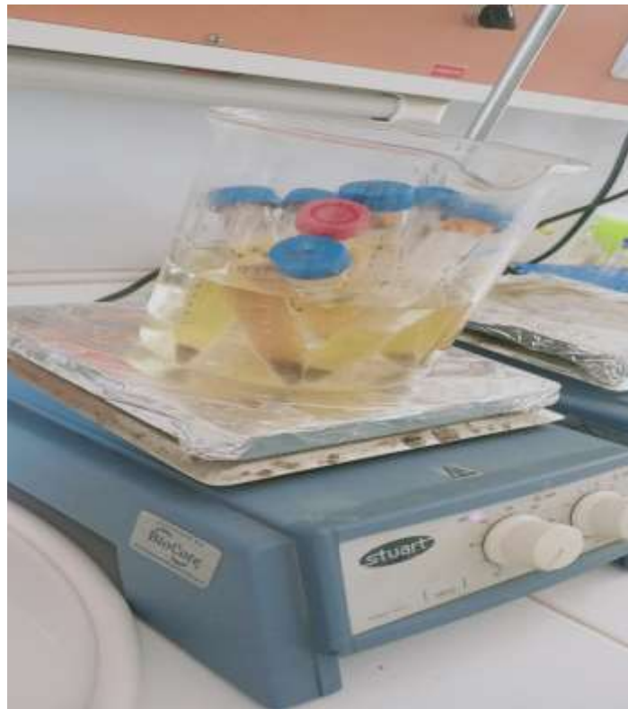
FIGURE 8 : Extraction du chrome hexavalent à partir des échantillons de sol.
