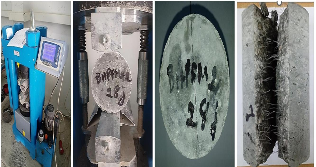
Figure 2. 19 La résistance à la traction par fendage mesurée sur des échantillons écrasés à 28 jours
