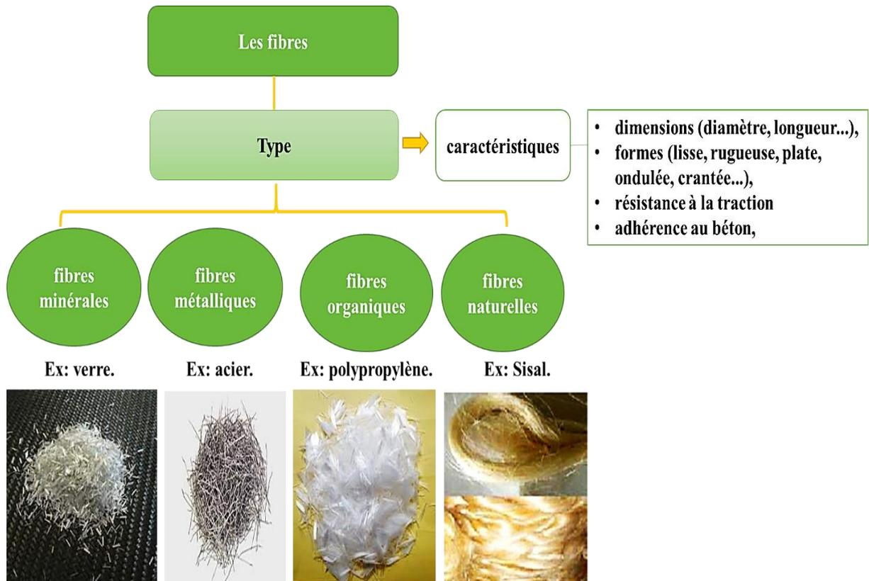
Figure 1.12 Catégories et caractéristique des fibres.
