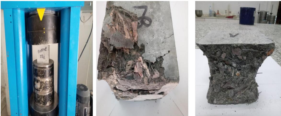
*Figure 2. 17 La résistance à la compression mesurée sur des échantillons écrasés à 28 jours*
