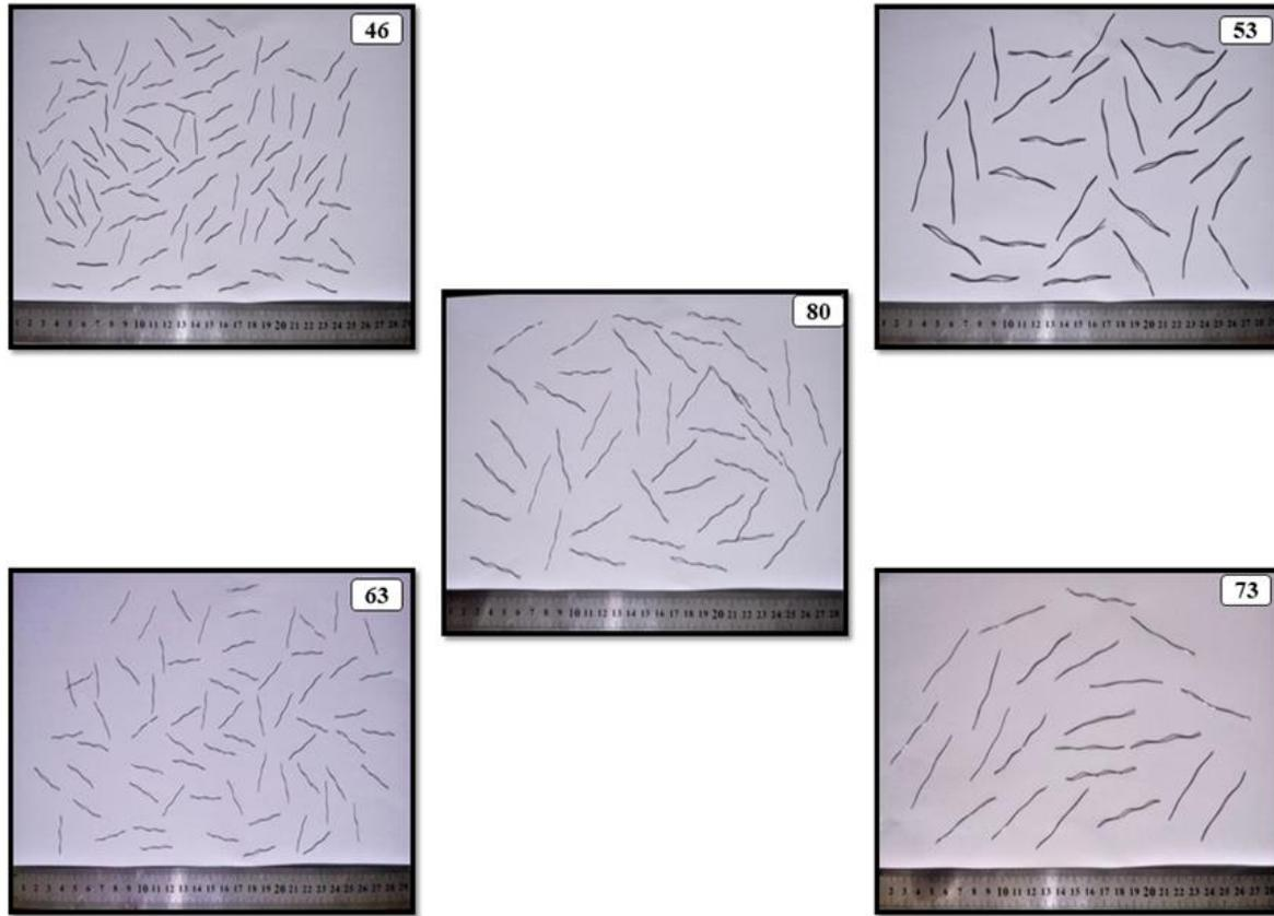
Figure 2. 10 Rapports d'aspect ( $L/d$ ) des fibres utilisées.
