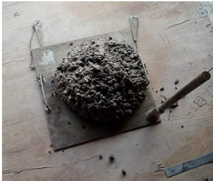
*Figure 2. 16 Essai d’Affaissement.*
