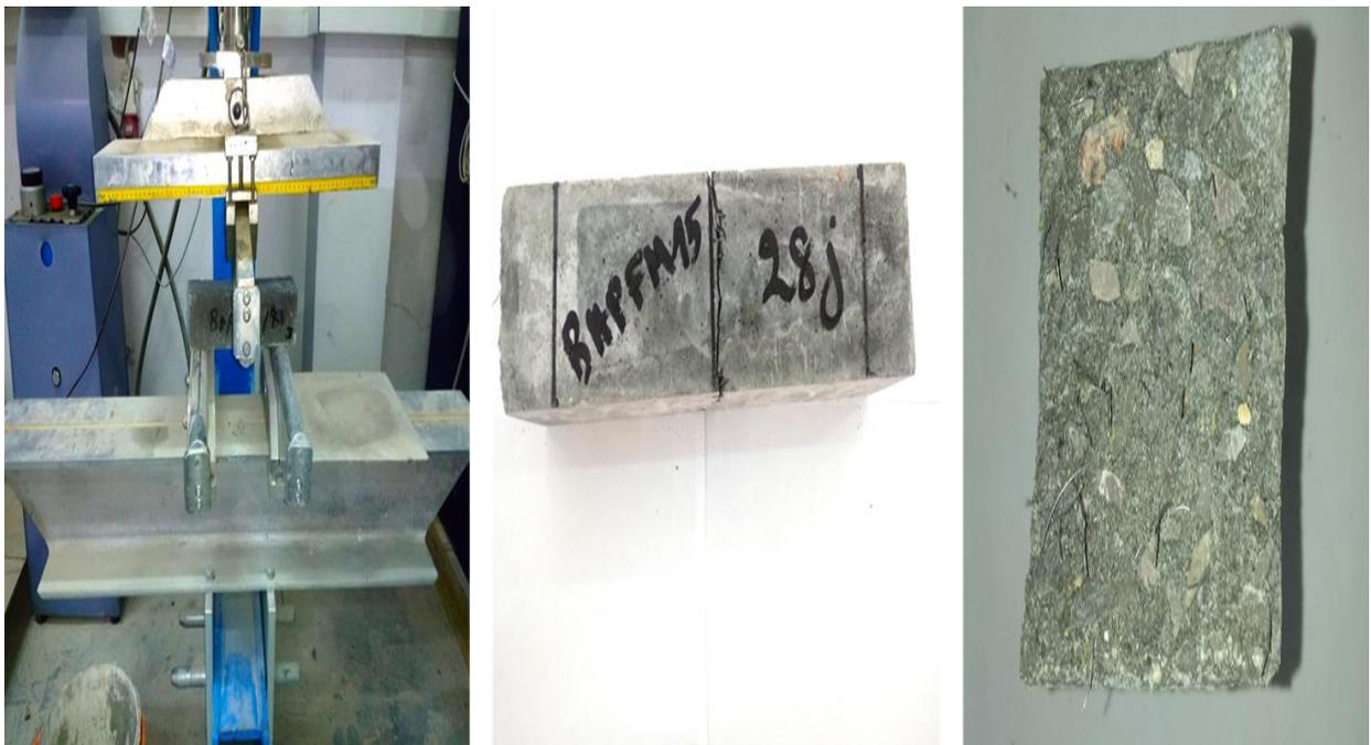
*Figure 2. 18 La résistance à la flexion mesurée sur des échantillons écrasés à 28 jours*
