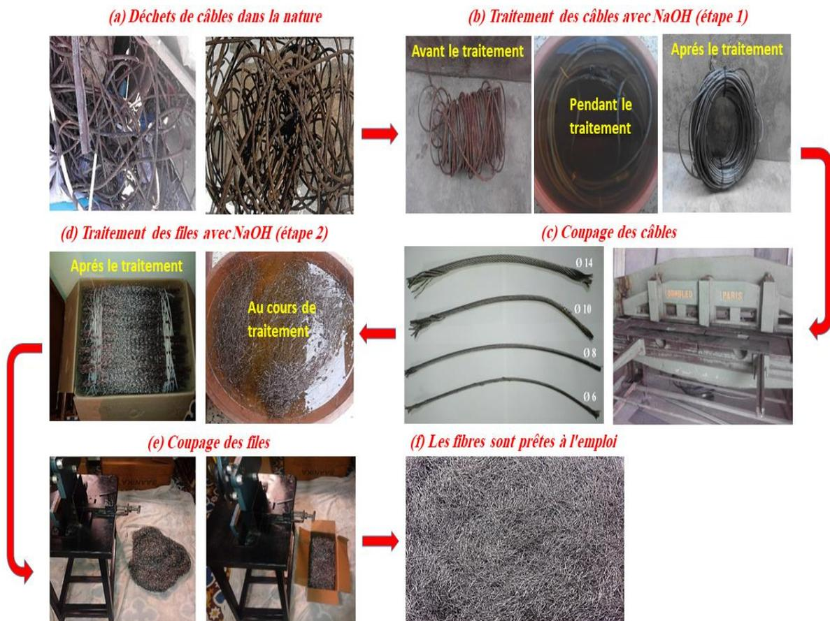
Figure 2. 9 Préparation et traitement NaOH des câbles recyclés.
