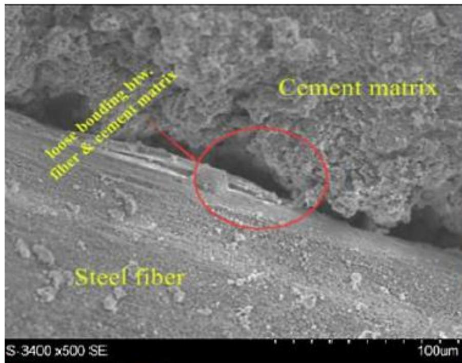
*Figure 1.42 L'interface fibre-pâte dans le ciment renforcé de fibres d'acier [98].*
