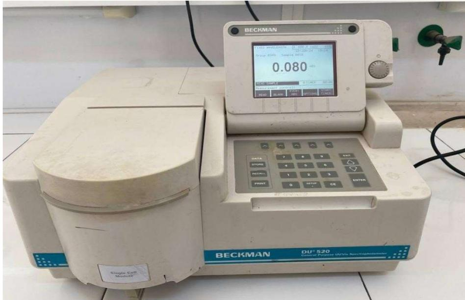
Figure 8 Mesure de la densité optique (DO) par un spectrophotomètre (Photo Originale, 2024).
