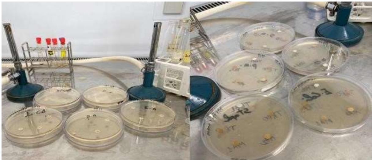
*Figure 10* Application des disques d'antibiotiques et les disques des extraits (Photo Originale ,2024).
