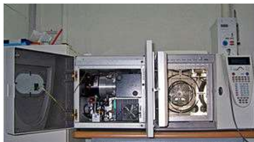
Intérieur d'un CPG-SM, avec la colonne de chromatographie en phase gazeuse .
