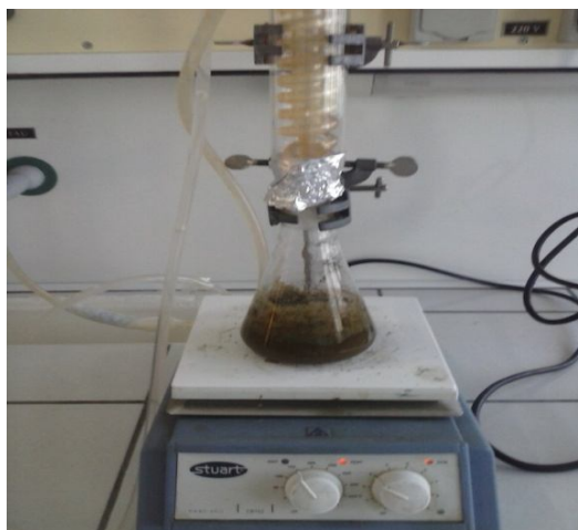
Photo 01 : montage d'extraction par macération dans l'eau
