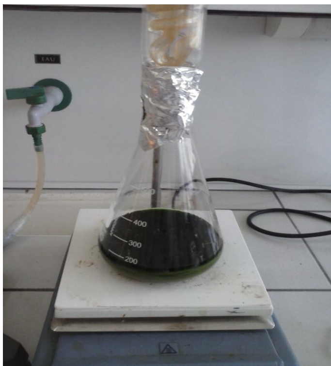
Photo 02 : montage d'extraction par macération dans l'éthanol
