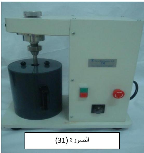
الصورة (31): جهاز يقوم بتحضير عجينة الورق لاستعمالها في عملية الترميم
