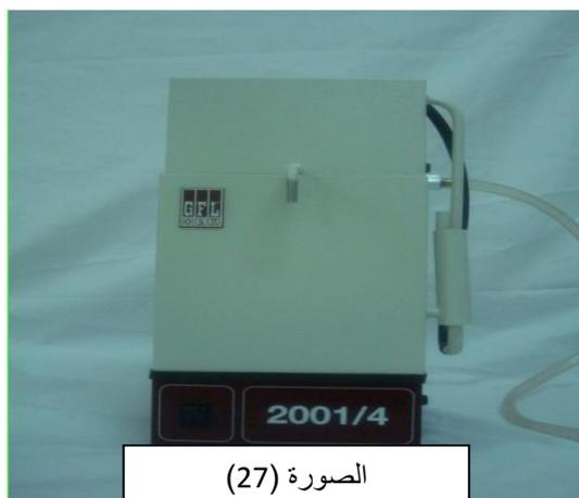
الصورة (27): جهاز تقطير الماء يحول الماء العادي الى ماء مقطر ويستعمل لتنظيف الورق
