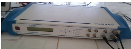
Figure III.5: Schéma de l'instrument électrochimique PGP201 Potentiostat
