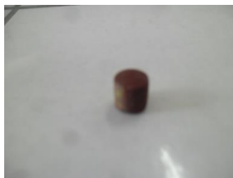
Figure III.2 : Echantillon de cuivre utilisée dans la technique perte de masse
