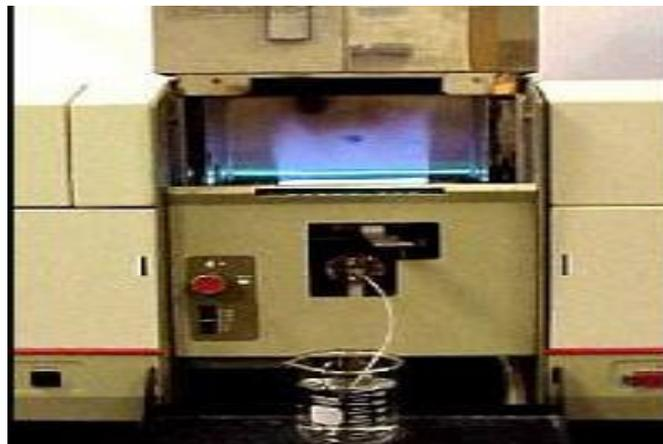
**Figure II-1 : Spectromètre d’Absorption Atomique**
