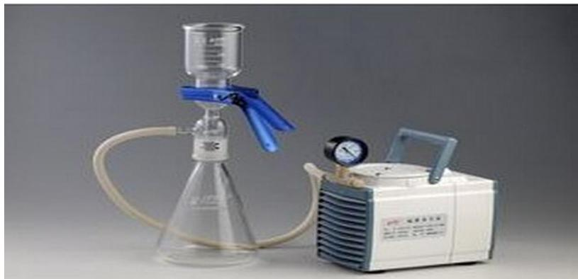
**Figure II-3 : Dispositif de Filtration sous vide**
