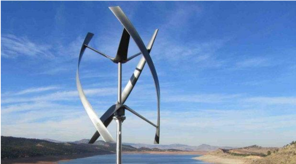
Figure. II. 3. Éoliennes axe vertical de Darrieus
