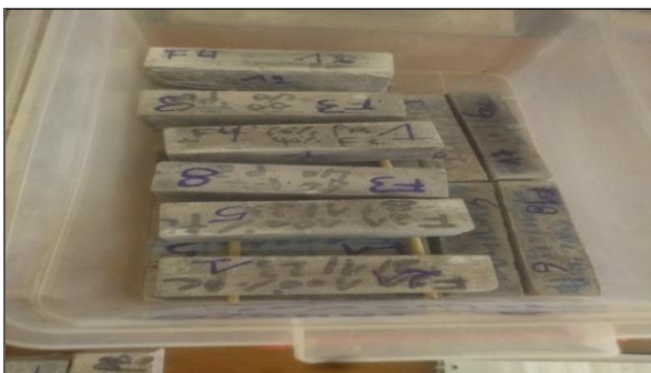
Figure 4.18. Conservation des éprouvettes dans l'Eau Pure
