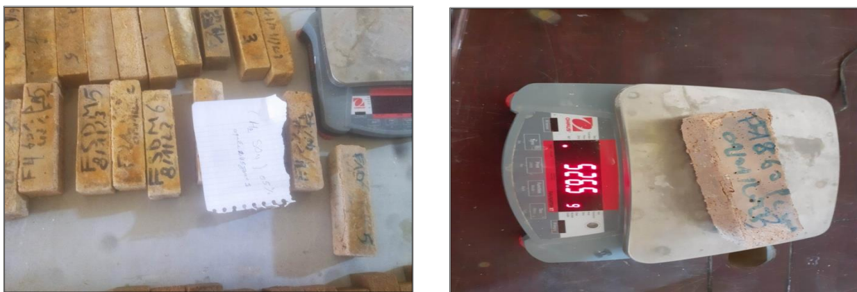
Figure 4.18. Mesure de la perte de masse à l'aide d'une balance électronique.
