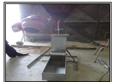
Figure 4.9. Exemple temps d'écoulement au V-funnel sur BSAP frais (cas de la formulation F1).
