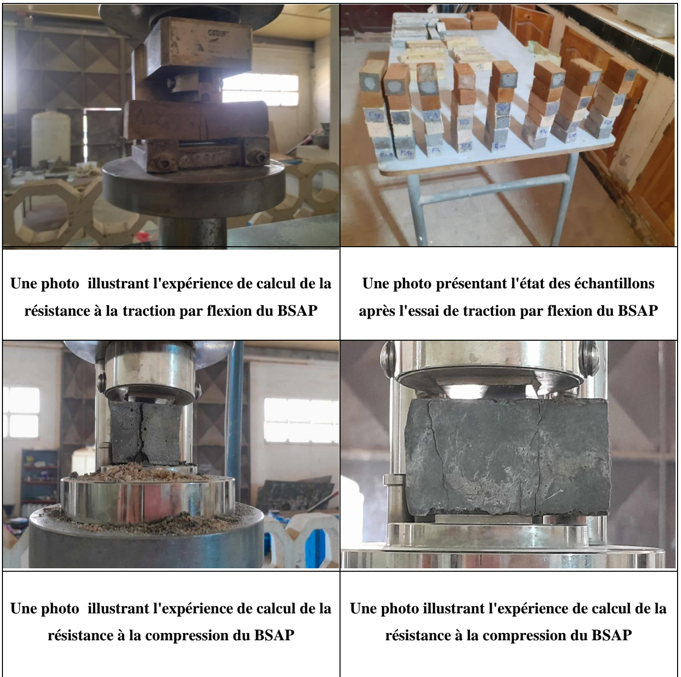
Figure 4.27. Photographies des échantillons pendant les essais mécaniques sur le BSAP.
