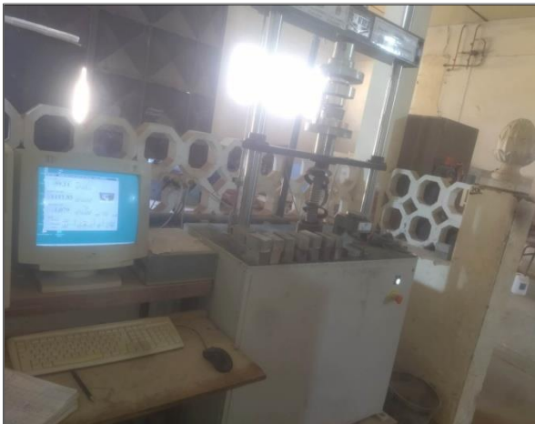
Figure 4.21.a. Lecture des résultats de l'essai de traction par flexion
