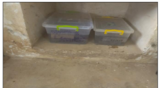
Figure 4.18. Conservation des éprouvettes dans l'Eau Pure
