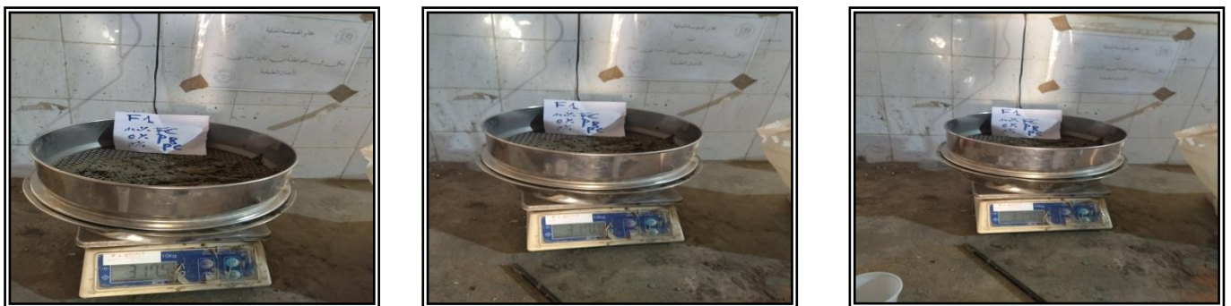
Figure 4.13. Exemple de l'essai de la stabilité au tamis sur BSAP frais. (cas de la formulation F1).
