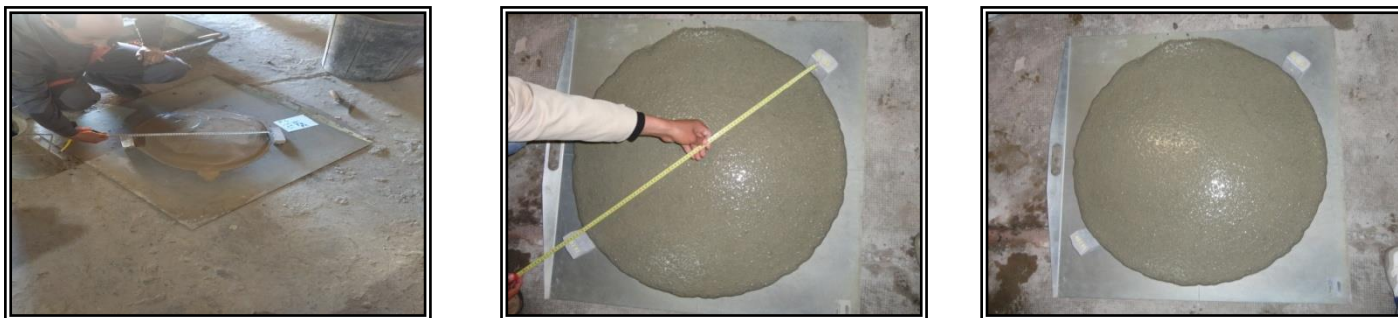
Figure 4.4. Exemple d'étalement sur BSAP frais (cas de la formulation F1).
