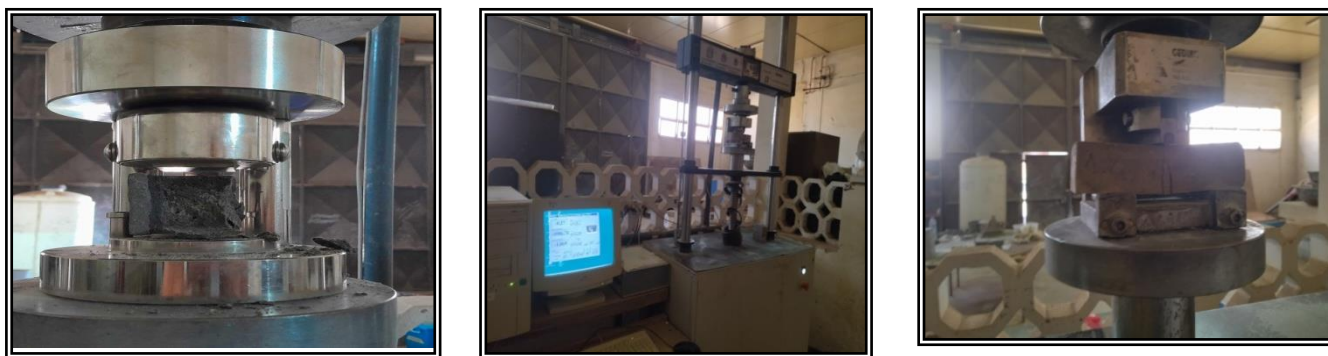
Figure 4.16. Exemple du procédé de mesure de la résistance à la compression et à la flexion du BSAP (formulation F1).
