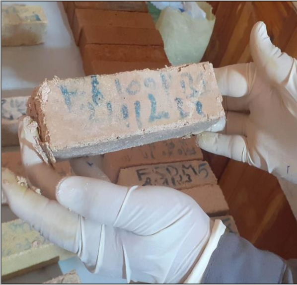
Figure 4.20. Une couche de sous-produits blancs recouvre l'extérieur des échantillons immergés dans le milieu acide H_2SO_4 , avec le FSDM comme exemple.
