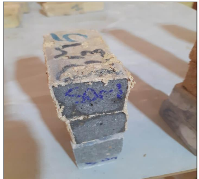
Figure 4.20. Une couche de sous-produits blancs recouvre l'extérieur des échantillons immergés dans le milieu acide H_2SO_4 , avec le FSDM comme exemple.
