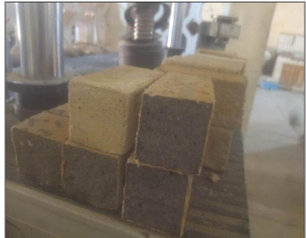
Figure 4.21.b. La forme des échantillons après l'expérience de flexion
