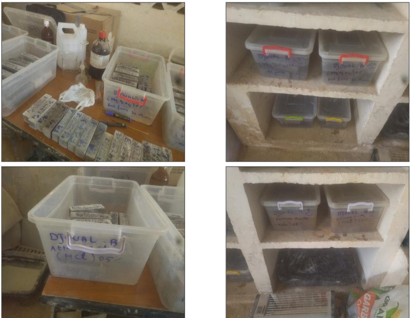
Figure 4.17. Conservation des éprouvettes dans les milieux agressifs : 5% HCl et 5% H_2SO_4
