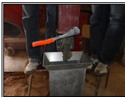
Figure 4.9. Exemple temps d'écoulement au V-funnel sur BSAP frais (cas de la formulation F1).
