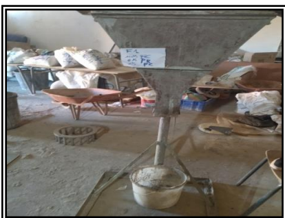
Figure 4.9. Exemple temps d'écoulement au V-funnel sur BSAP frais (cas de la formulation F1).
