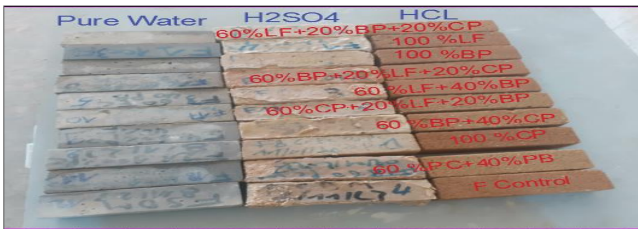
Figure 4.19. Comparaison visuel des éprouvettes exposées aux différents milieux (âge 90 jours)
