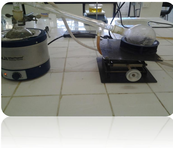
Photos 1: Montage d'hydro-distillation employé pour l'extraction de l'huile essentielle.
