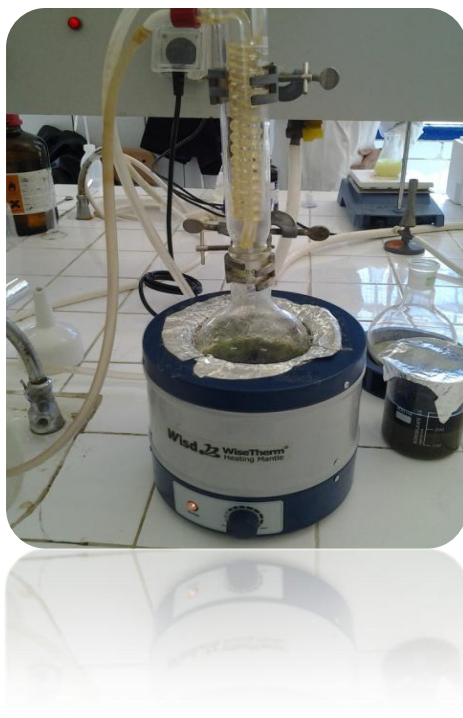
Photos 4 : l'extraction de romarin avec l'alcool primaire à reflux.
