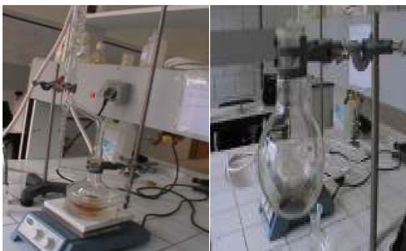
Figure III. 4 : méthode d'extraction, (1) : Evaporation de l'extrait ;(2) : extrait sec
