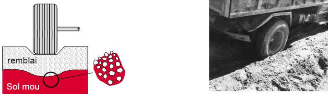
Figure1.26. Mécanismes typiques de dégradation des routes non revêtues et non renforcées sur les sols mous.
