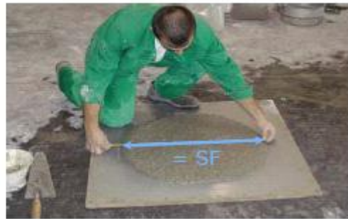
Figure I.6 : essai d'étalement au cône (slump flow)
