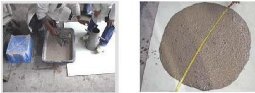
Figure I.10: Détermination de l'étalement.
