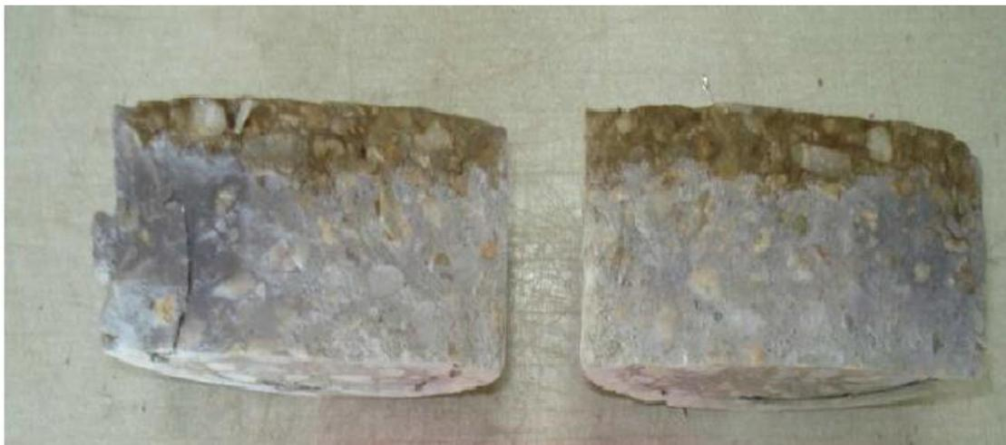
Figure.II.11: Eprouvettes affectées par les ions chlorures[54].
