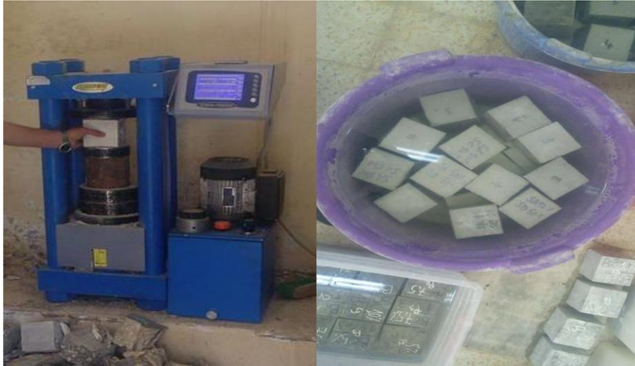
**Figure III.11: la presse hydraulique de compression pour béton
