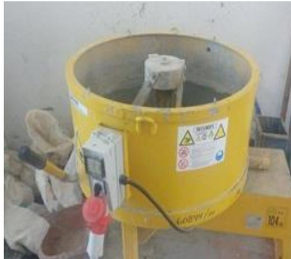
Figure III.7: Malaxeur de béton à axe vertical (université de Djelfa )
