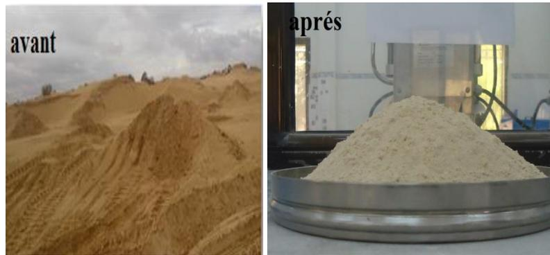
Figure .III.5: Le sable de dune avant et après broyage.
