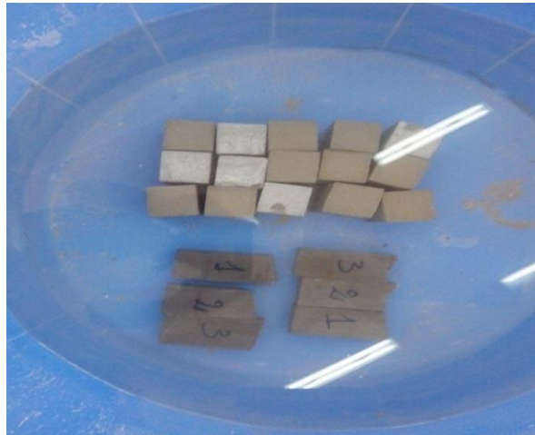
Figure. IV.9. Immersion des éprouvettes dans un bac
