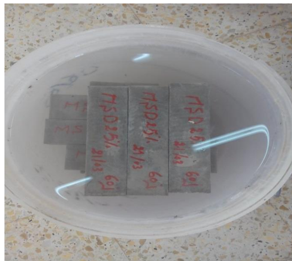
Figure. IV.3. Conservation des éprouvettes dans l'eau
