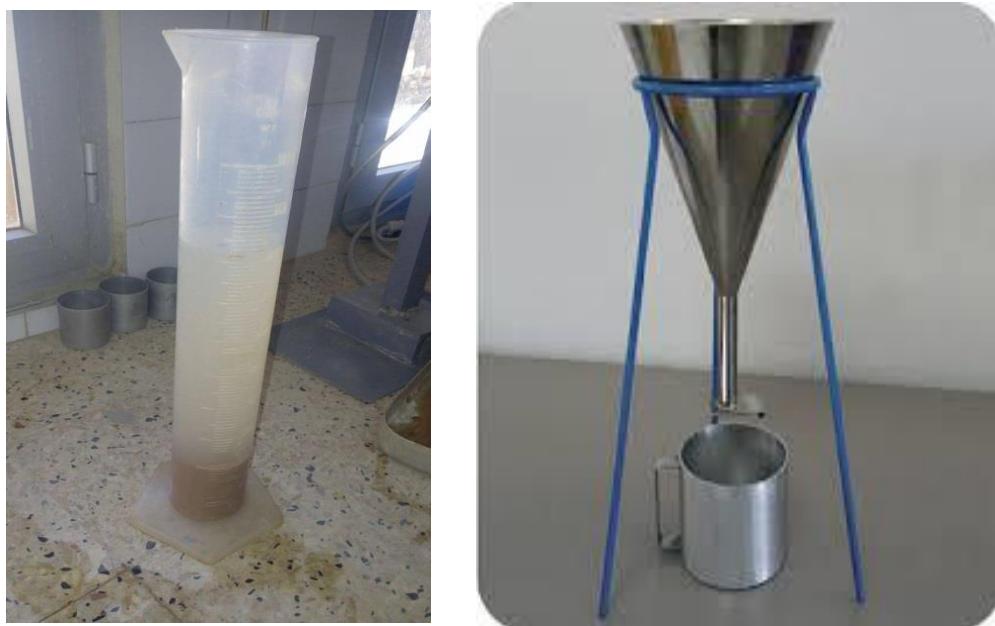
Figure. II.1. Méthode de mesure de la masse volumique absolue et apparente
