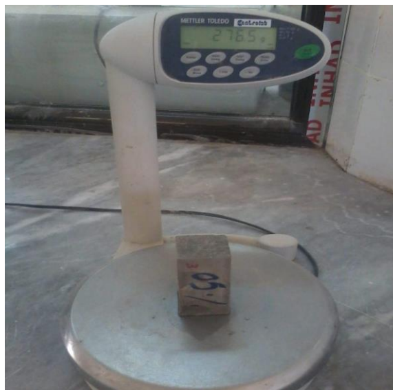
Figure. IV.10. Mesure la masse de l'éprouvette saturée
