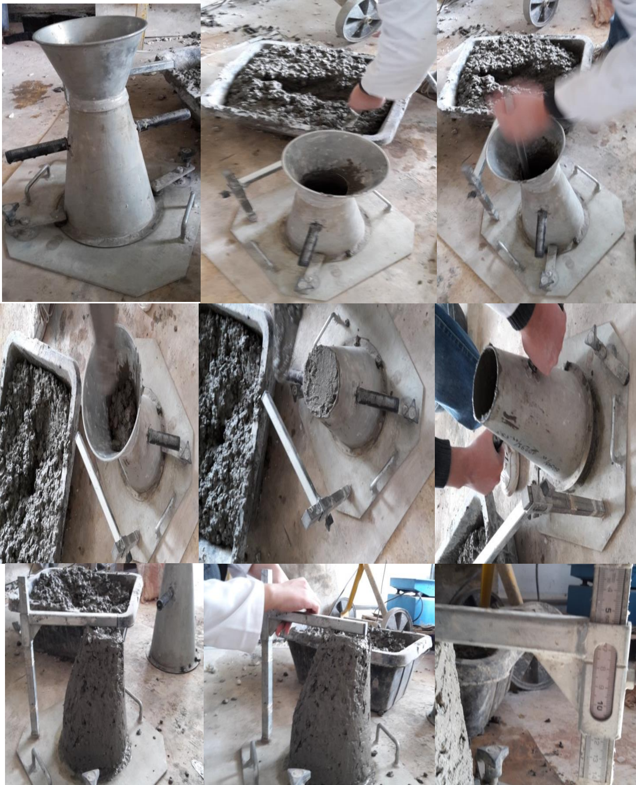
Figure 6.12. Essai d'affaissement au cône d'Abrams.
