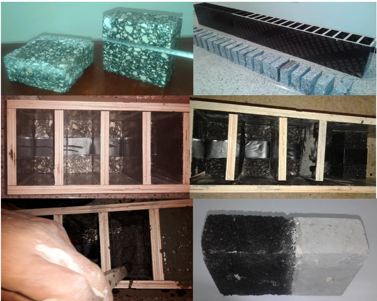
Figure 6.13. Les étapes de préparation des échantillons composite Blanc/Noir avec fissure d'interface centrale.
