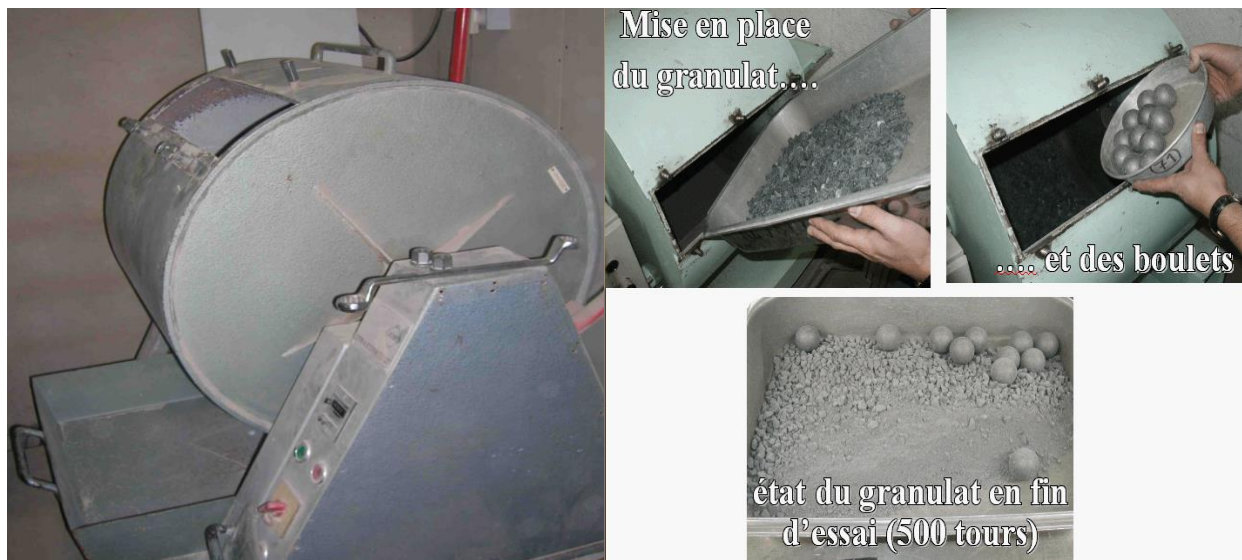
Figure 6.1. Principe d'essai de Los Angeles.
