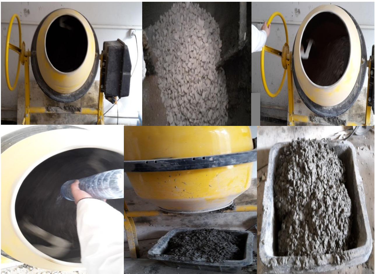
Figure 6.14. Étapes de formulation du béton.
