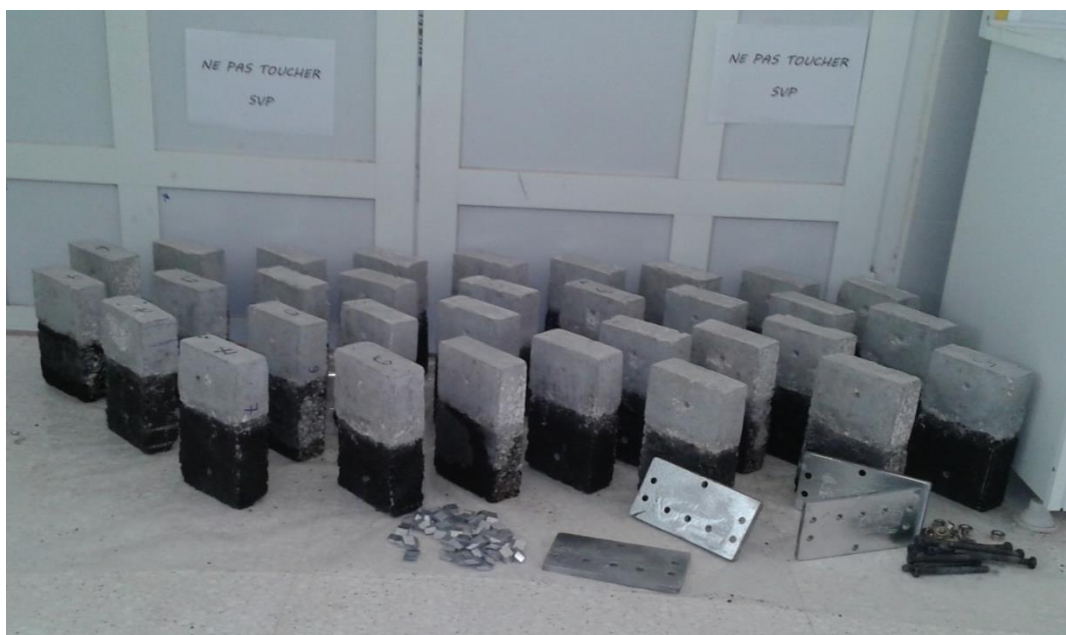
Figure 7.10. Echantillons d'un mois d'âge de béton bitumineux avec des longueurs de fissures de : 2a = 5\text{cm} , 7\text{cm} et 9\text{cm} .
