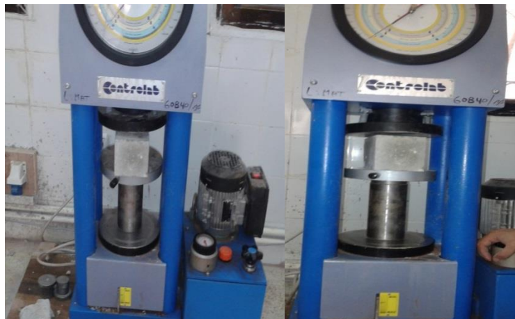
Figure 6.16. Mesure de la résistance en compression du béton.
