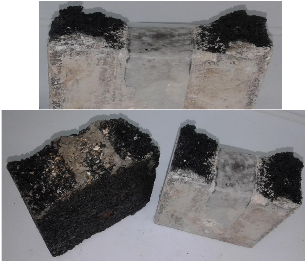
Figure 7.6. Une photo d'une rupture interfaciale.
