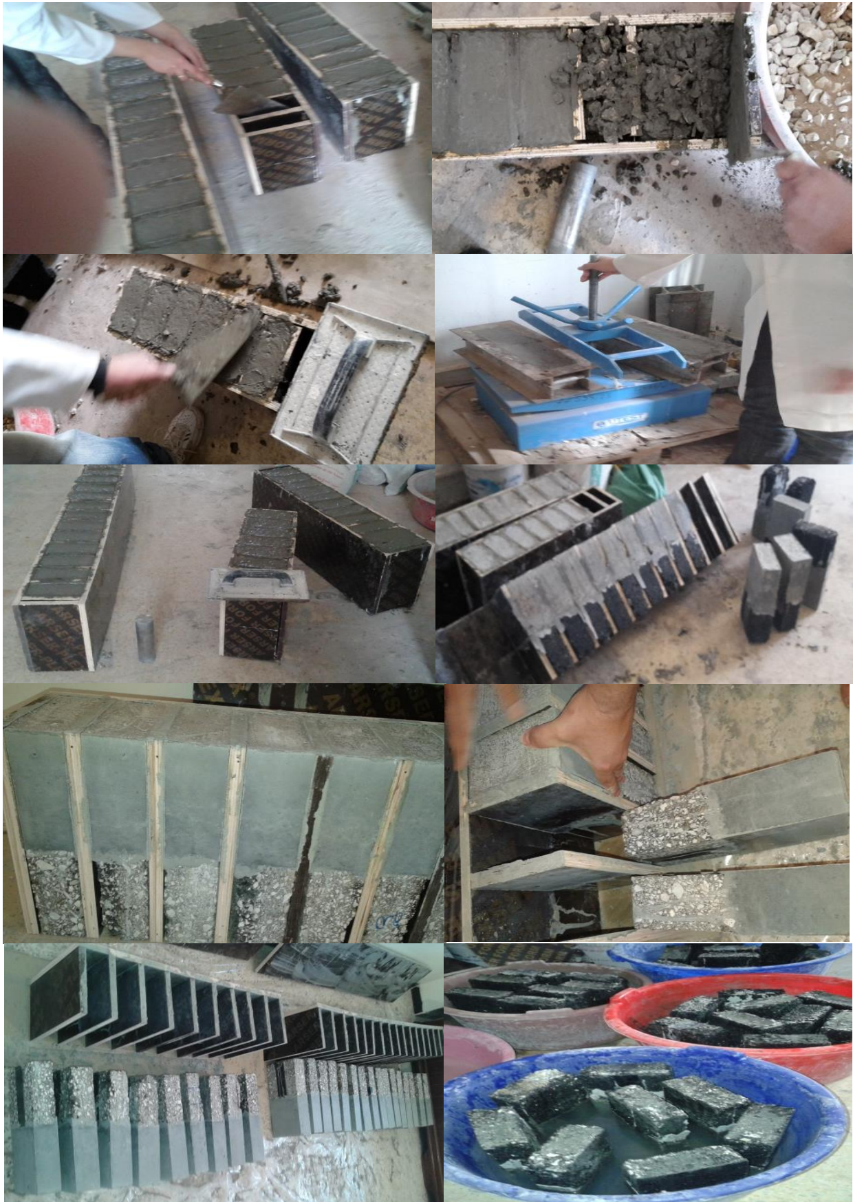
Figure 6.15. Étapes de formulation des bétons et conservation des éprouvettes.
