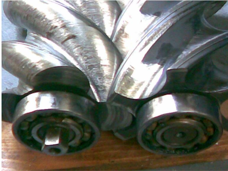
**Figure III.4: Endommagement du démarreur pneumatique de la turbine à gaz**
