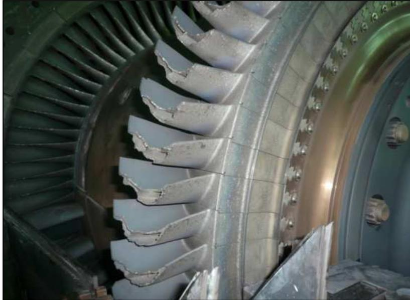
**Figure VI.3. Usure des ailettes du compresseur axial**
