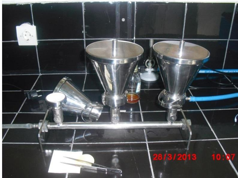
**Figure 11.** Dispositif de filtration sur membrane.
