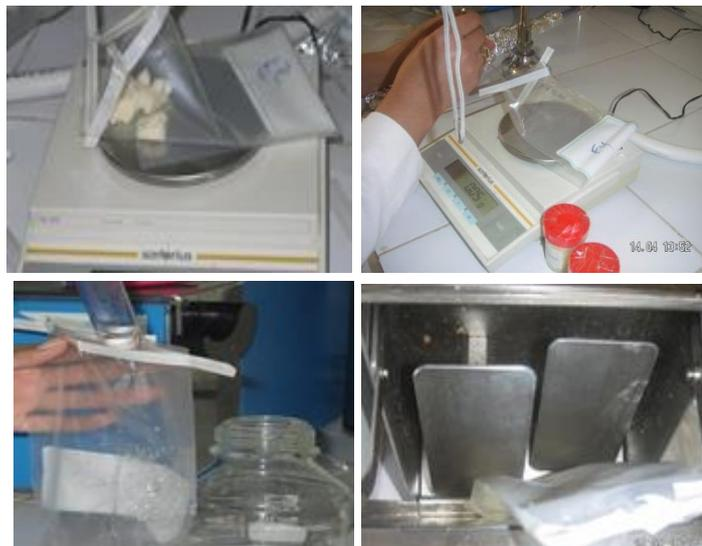
**Figure 25 :** Préparation des dilutions décimales (Cas des produits solides).
