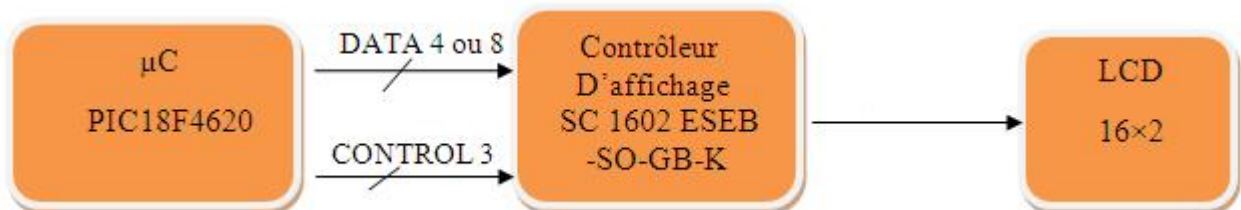
Figure III.8 : Communication avec l'afficheur LCD
