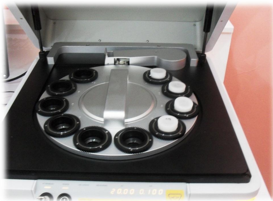
Figure 19. Disposition des échantillons dans le spectrophotomètre à rayons X.
