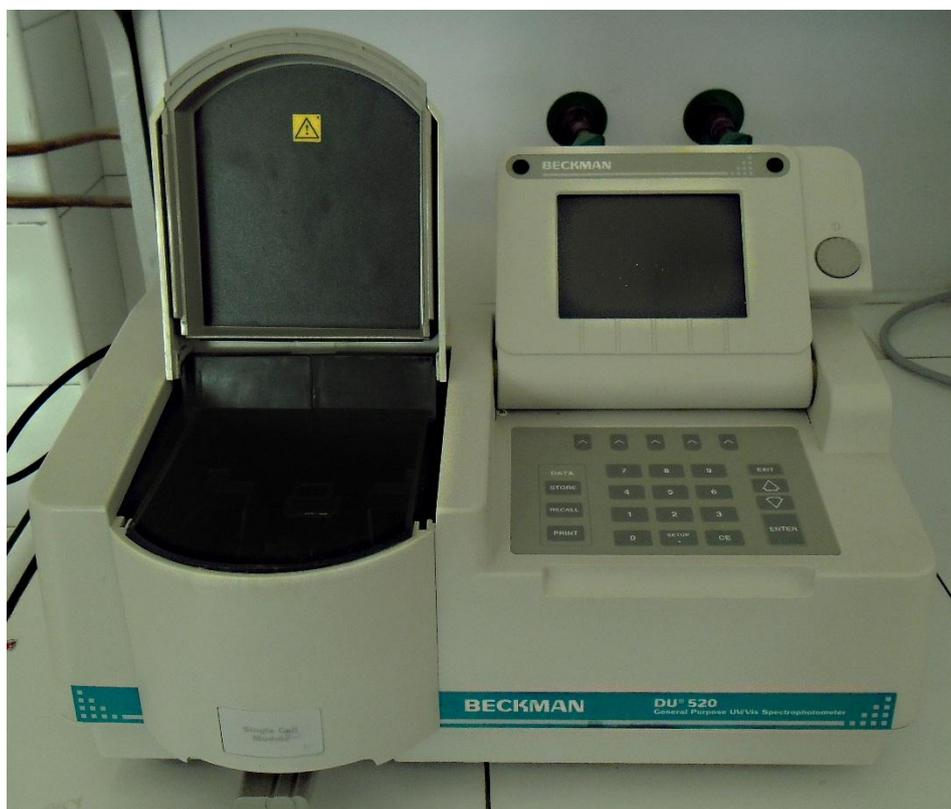
**Figure 4.** Spectrophotomètre (Beckman DU 520 General purpose UV/Vis spectrophotometer )
