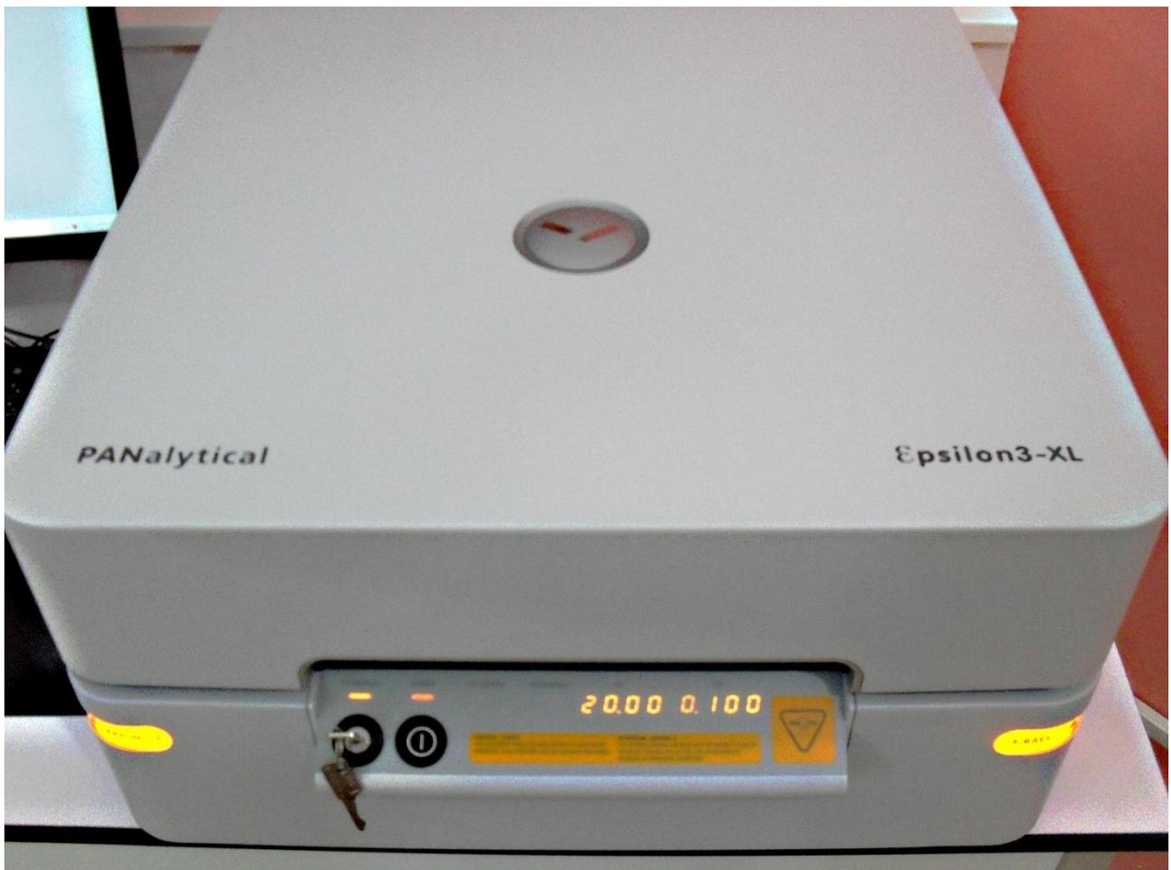
**Figure 5.** Spectrophotomètres à rayons X (PANalytical Epsilon3-XL)
