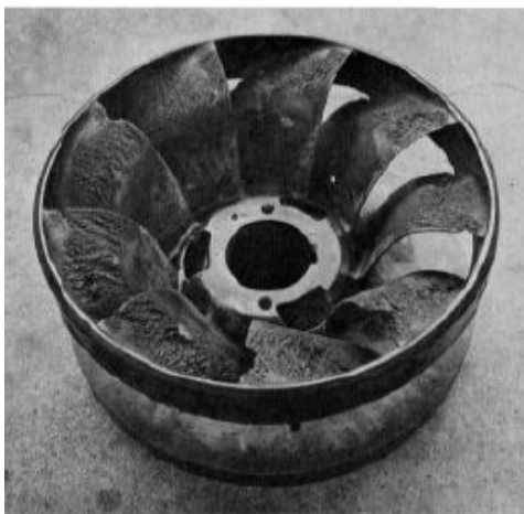
Figure 4.1 : érosion de cavitation sur les aubages de la roue d'une pompe
