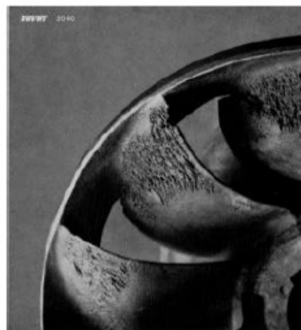
Figure 4.1 : érosion de cavitation sur les aubages de la roue d'une pompe
