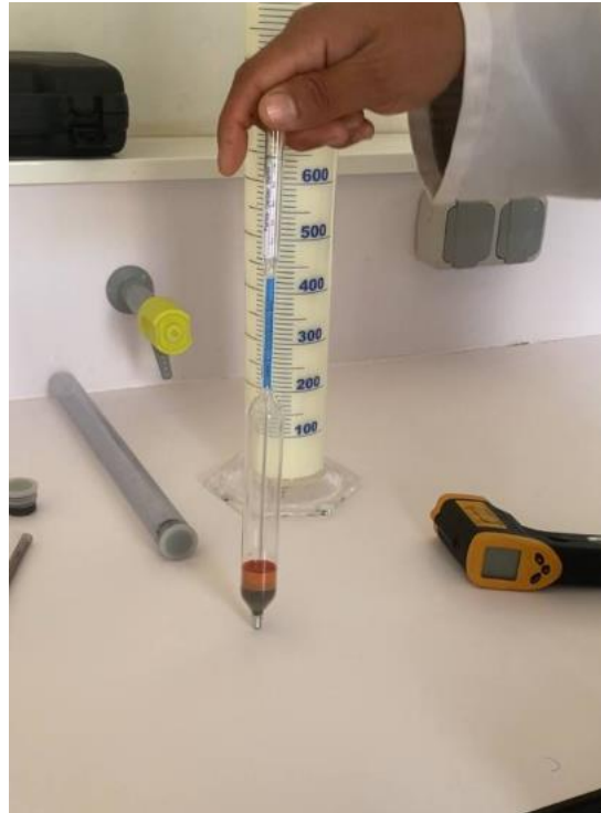
Figure 10: Mesure de la densité du lait cru à l'aide du lactodensimètre (Origine, 2025)
