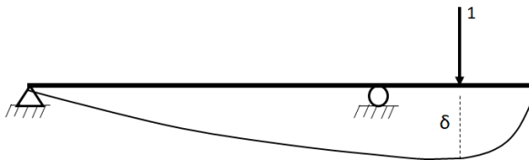
FIG. 3.9 – Déformée due à une charge unitaire.
