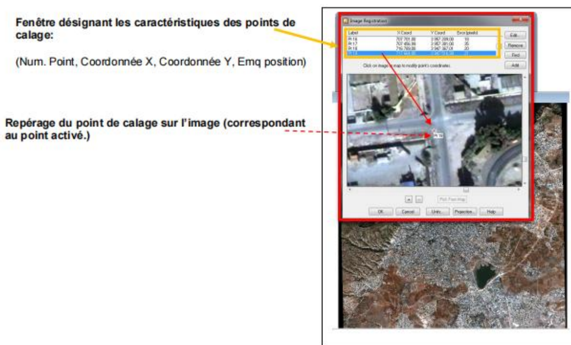
Fig : exemple de calage
