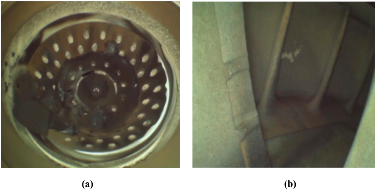
Figure II.2 : (a) Dépôt de carbone asymétrique dans le moteur et (b) l'une des aubes de turbine frappée par la chute de carbone [86].
