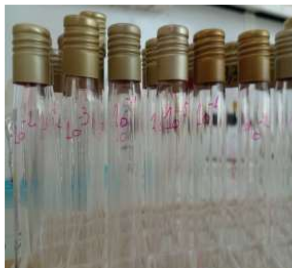
Figure 17 : Tubes de dilution préparés pour la réalisation des dilutions décimales (Photo personnelle).
