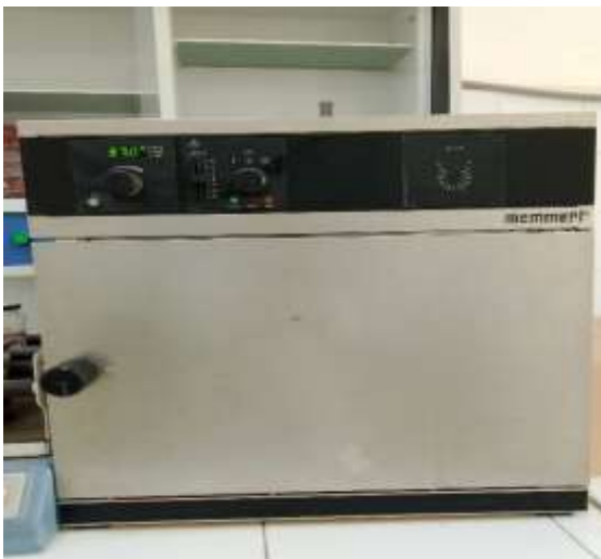
Figure 08 : Vue externe de l'étuve de laboratoire (Photo personnelle)
