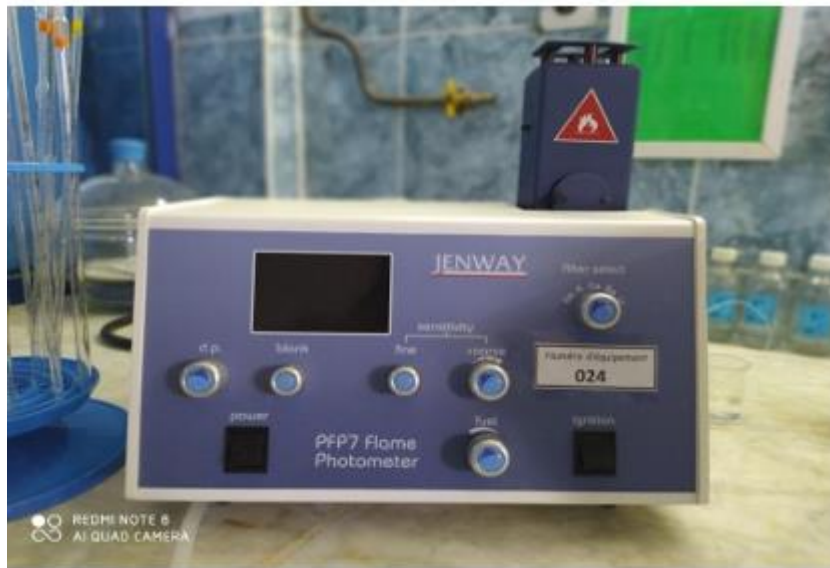
Figure 4 : Dosage de Sodium ( \text{Na}^+ ) et Potassium ( \text{K}^+ ) (Khelif & Labboun, 2021)
