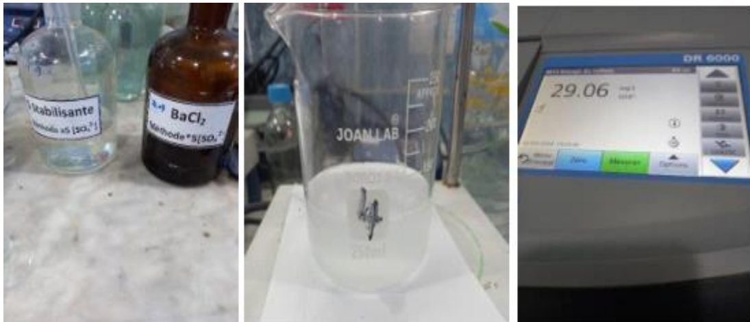
Figure 6 : Dosage des sulfates ( \text{SO}_4^{2-} ) (Laimeche, 2024)
