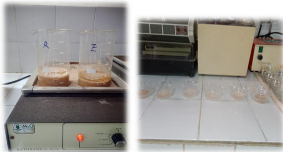
Figure 12 Four électrique à moufle et bain de sable (Bathisand) pour la calcination des échantillons de sol. Creusets contenant les échantillons de sol avant (A) et après calcination (B).
