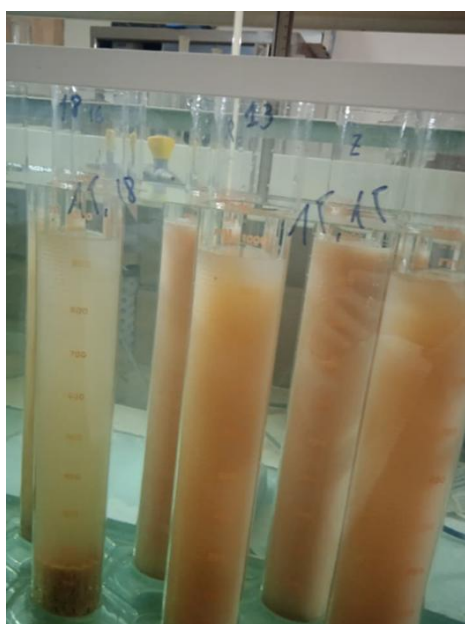
Figure 8 Cylindres gradués de sédimentation pour la séparation des fractions argileuses et limoneuses selon la méthode de Robinson.
