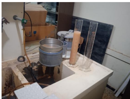
Figure 9 Tamisage de la fraction sableuse à 50 \mu\text{m} .
