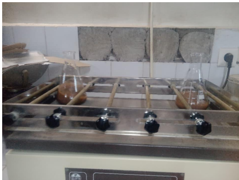
Figure 7 Agitateur rotatif pour la dispersion des suspensions de sol (fermes de Zaina et Ras El Aïoun, Djelfa).
