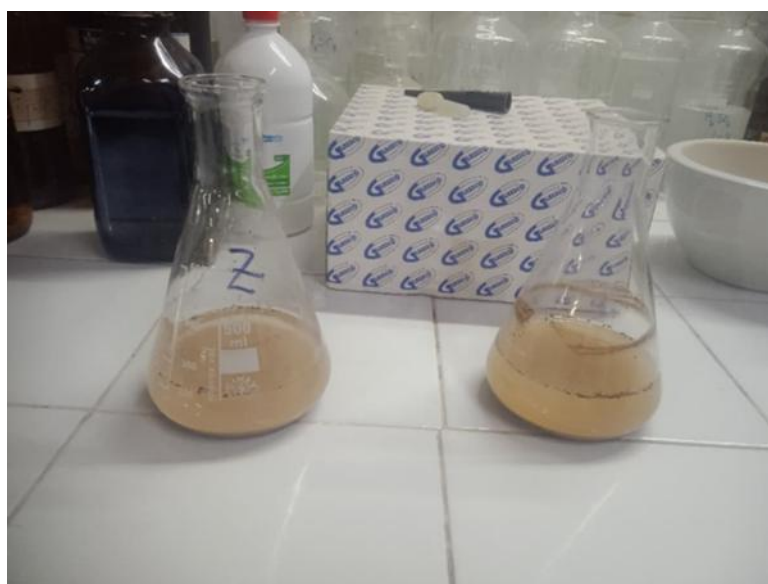
Figure 11 Fioles à doigt contenant les échantillons de sol (R = Ras El Aïoun, Z = Zaina) avant attaque acide.
