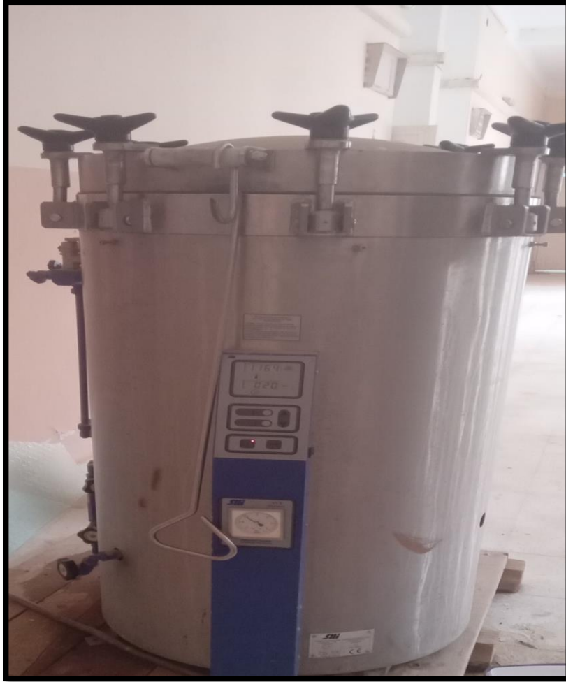
Figure8 :Stérilisation des milieux de culture à l'autoclave à 121°C. (Photo originale, 2026)
