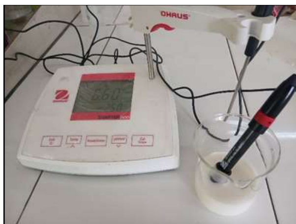
Figure7 : Détermination du pH du lait par pH-mètre électronique.
