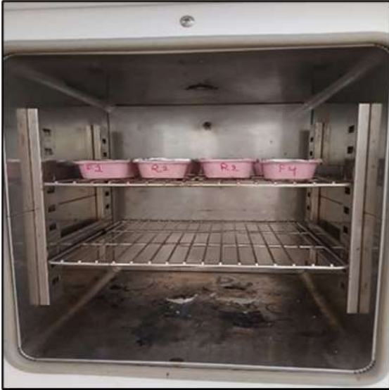
Figure 8 : Étuvage des échantillons de matière sèche de fromage pour analyse
