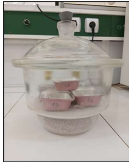
Figure 9 : Mise des échantillons dans un dessiccateur
