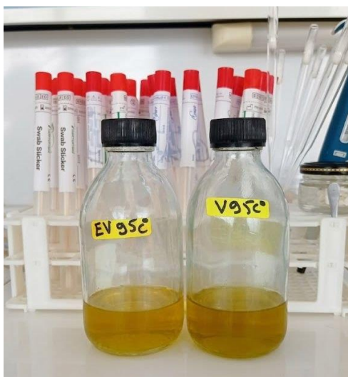
Figure 15 : Conditionnement des échantillons d'huiles d'olive dans des flacons en verre avant l'application du traitement thermique.
