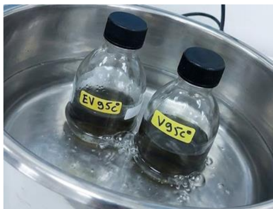
Figure 16 : Traitement thermique des huiles d'olive vierge et extra vierge par chauffage au bain-marie à 95 °C.
