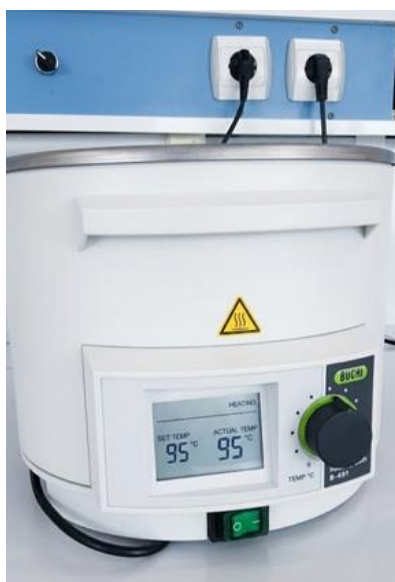
Figure 17: Paramètres thermiques appliqués aux huiles d'olive lors du chauffage (95 °C / 40 min).
