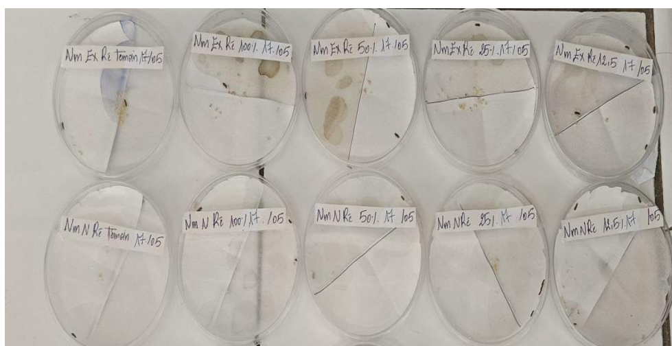
Figure 13. Dispositif expérimental du test de fumigation (répulsion) sur Tribolium castaneum .
