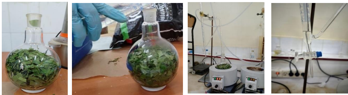
Figure 14. Méthode d'extraction de l'huile essentielle de Laurus nobilis
