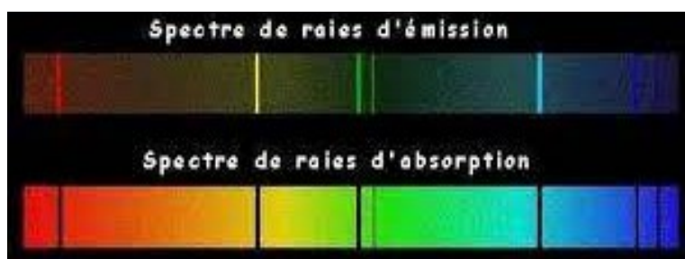
Figure 1.10 : Spectres de raies : d'émission et d'absorption.
