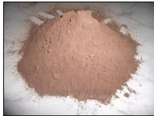
Figure II.5: Poudre de la pouzzolane naturelle de Beni-Saf après broyage, & < 80 µm.
